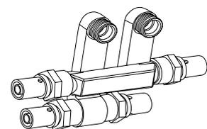
Anschlussnippel konisch dichtend, Set 2 Stück, direkter Heizkörperanschluss Rp 1/2, Sechskant, selbst dichtend durch O-Ring-Dichtung, Ventilanschluss G 3/4 mit Konus.
