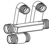
HERZ- Sockelleisten- Anschluss- Set für Lötanschluss, Messing vernickelt, für Ventil- und Kompaktheizkörper. Klemmsetanschlüsse heizkörperseitig M 22 x 1,5, rohrseitig Lötstufe 18 mm (3 **S333** 18) oder Innen/Aussen- Lötende 15/22 x 1 mm (3 **S333** 20). Klemmsets sind separat zu bestellen. Heizkörperanschluss mit Ventilanschlussbogen Set 3 **S344** 01 aus Kupferrohr 15 x 1 vernickelt. Ventile absperr- und entleerbar. Schenkellänge 150 x 150 mm.
