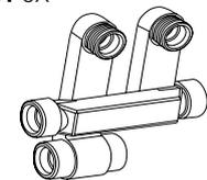
HERZ- Sockelleisten- Anschluss- Set für Pressanschluss, Messing vernickelt, für Ventil- und Kompaktheizkörper. Klemmsetanschlüsse heizkörperseitig M 22 x 1,5, rohrseitig Pressanschluss DN 14 x 2 – DN 20 x 2,5. Klemmsets sind separat zu bestellen. Heizkörperanschluss mit Ventilanschlussbogen Set 3 **S344** 01 aus Kupferrohr 15 x 1 vernickelt. Ventile absperr- und entleerbar. Schenkellänge 150 x 150 mm.
